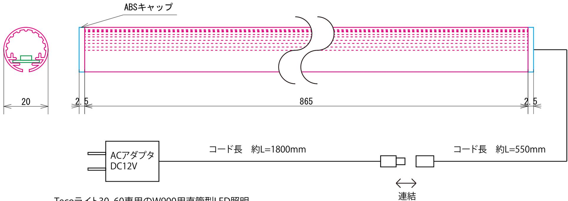
Tecoライト30、60専用のW900用直管型LED照明
